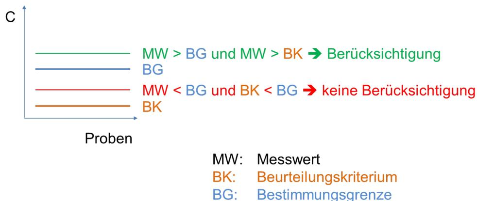
**Abbildung 4: Prüfung Einhaltung Beurteilungskriterium, in Abhängigkeit von Bestimmungsgrenze**
