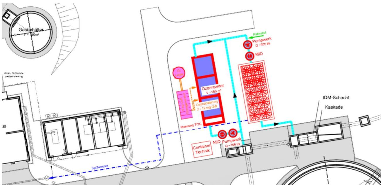
Abbildung 17: Lageplanausschnitt V3.1: Ozonung + kontinuierliche Filtration (IB Knollmann [100])
